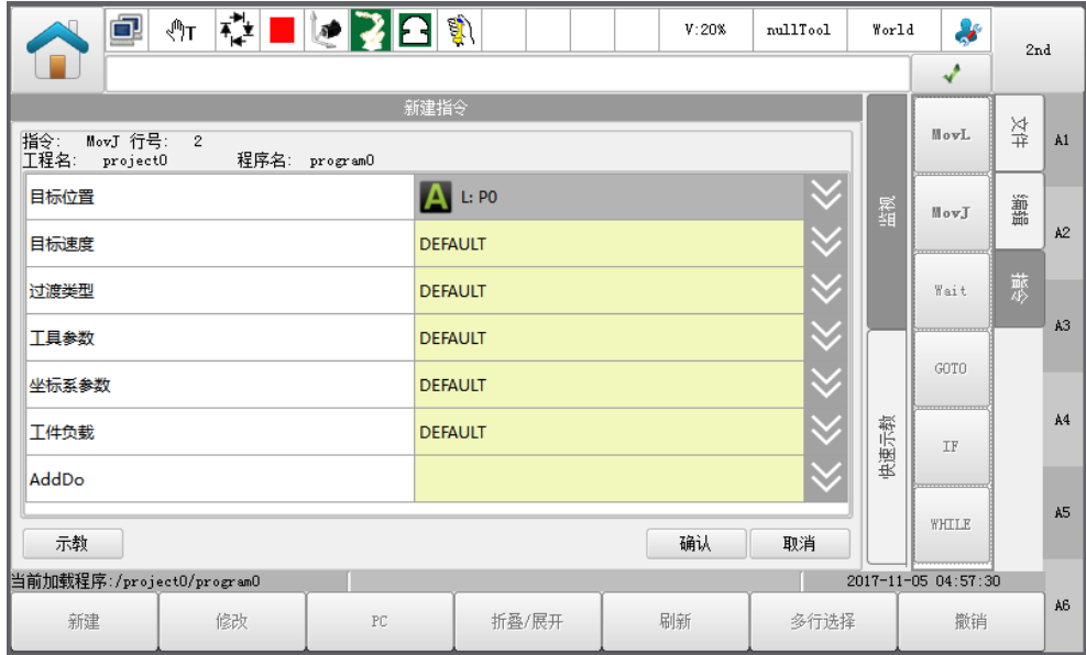
图4-11 编辑 MovJ 指令的参数
