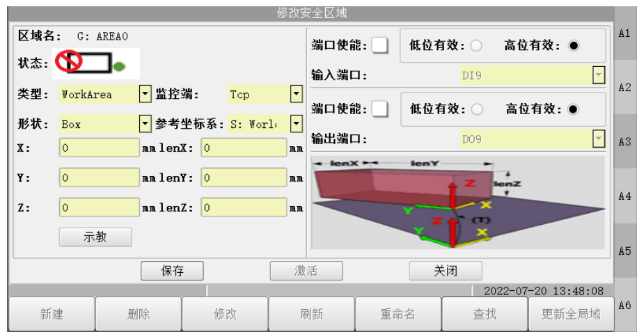
图7-2 设置标准区域变量界面---轴干涉区
