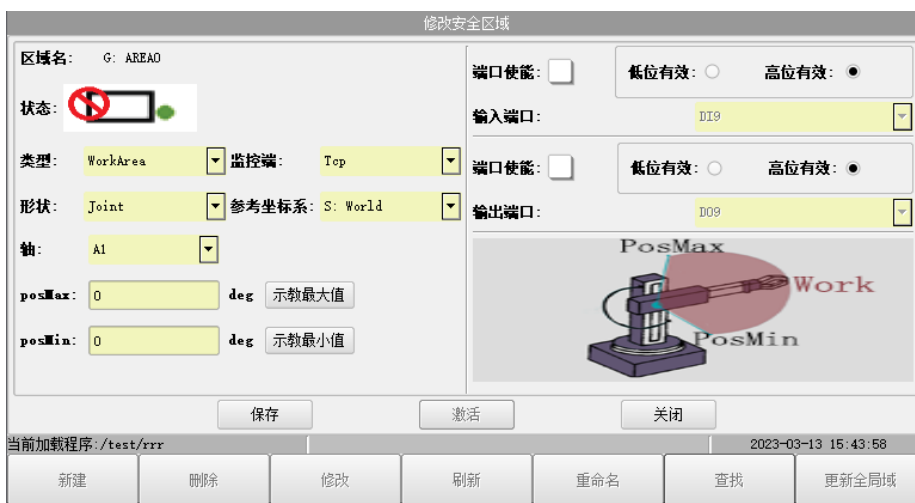
图7-2 设置标准区域变量界面---轴干涉区
