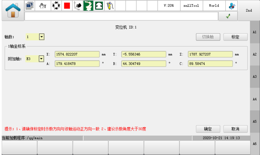
图7-86 变位机 ID=1 的设定或示教
